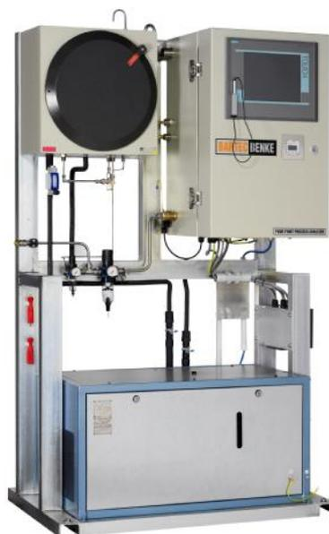
Рисунок 1 – внешний вид анализаторов PPA-4.
